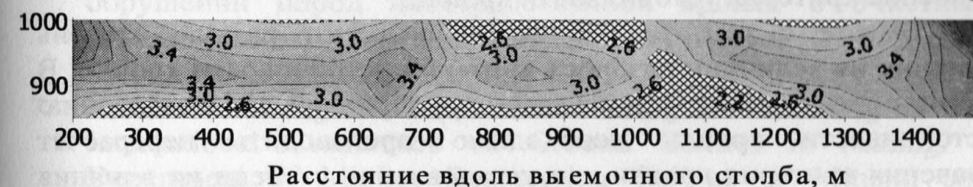
Рис. 5 Зоны прогнозируемого обрушения непосредственной кровли в пределах выемочного столба 2-й северной лавы при достоверности определения прочности пород 80%;
