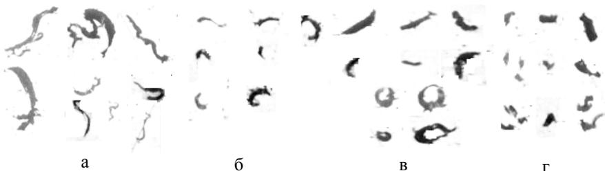
Рисунок 1. Виды стружек, образующихся при плоском алмазном шлифовании:
