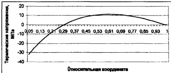
Рис. 1. Распределение термических напряжений по сечению корочки непрерывнолитой заготовки на выходе из кристаллизатора
