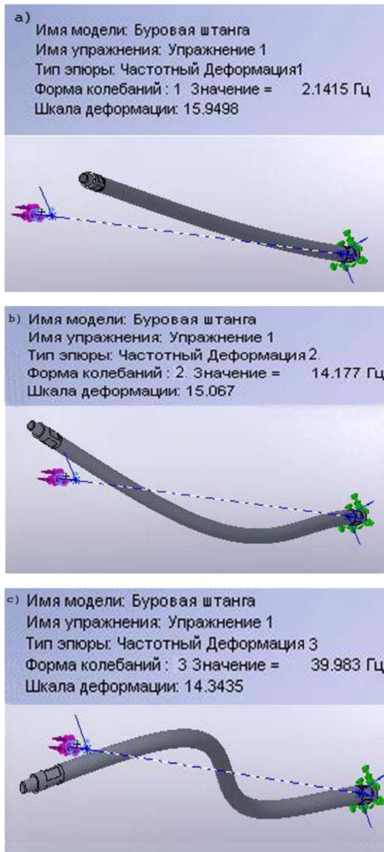
Рисунок 3. Формы и частоты собственных колебаний буровой штанги размером 180×50×8000 мм
