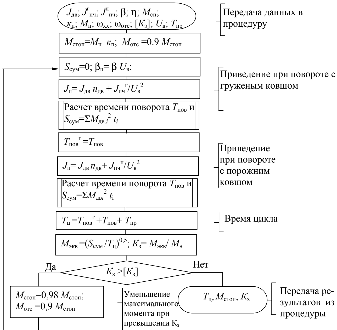
Рисунок 4. Схема алгоритма расчета времени цикла, коэффициента загрузки привода и максимального момента привода
