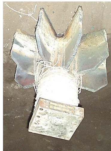
Рис. 4. Конструкция подового электрода НТФ «ЭКТА»[8].
