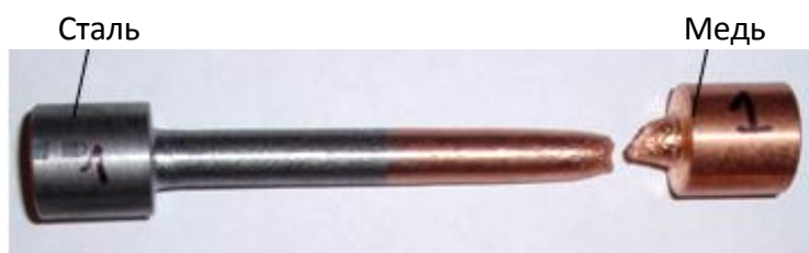
Рис.3–Образец стыка медь-сталь после механических испытаний.
