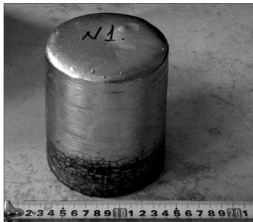
Рис. 3. Слиток ЭШП из титановой губки ТГ-110 (плавка 1)
