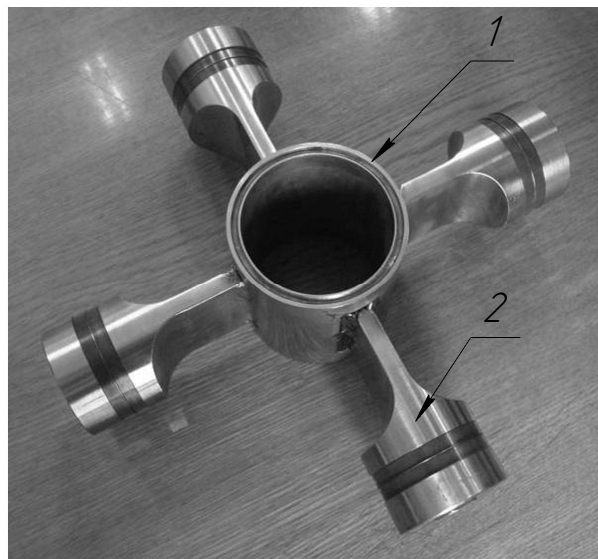
Рисунок 1 - Ультразвуковая кавитационная проточная камера в виде трубчатого вибратора (1 - трубчатый вибратор; 2 – ультразвуковой вибрационный привод с ножевидным трансформатором скорости)
