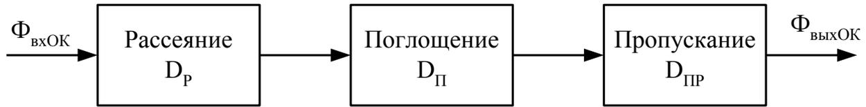
Рисунок 2 — Факторы, влияющие на изменение мощности излучения в оптическом канале газоанализатора
