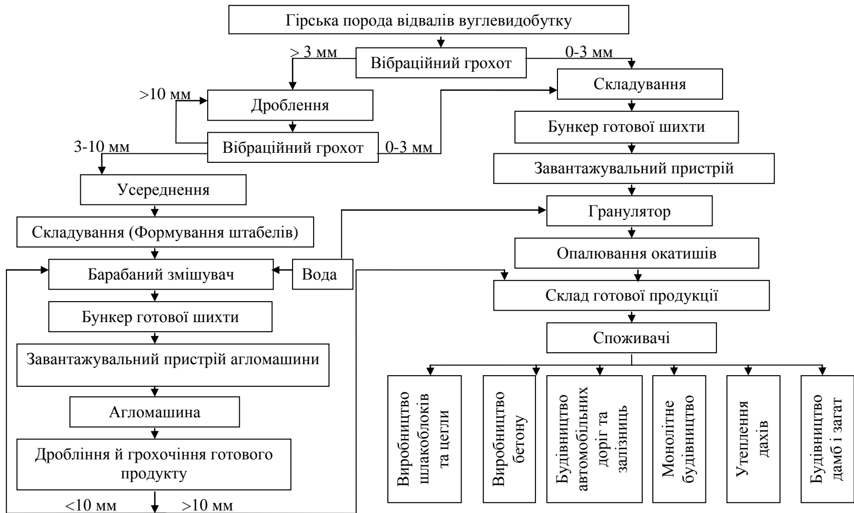
Рисунок 3 – Технологічна схема переробки відвалів вуглевидобутку методом окискування
