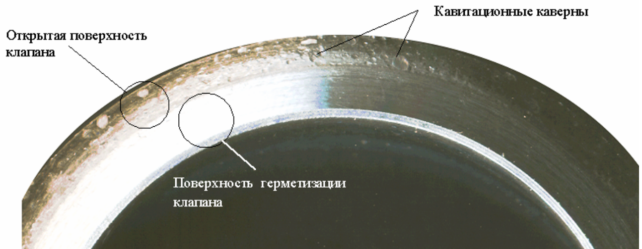
Рисунок 2 - Влияние кавитационной эрозии на поверхность запорного устройства после непродолжительной работы
