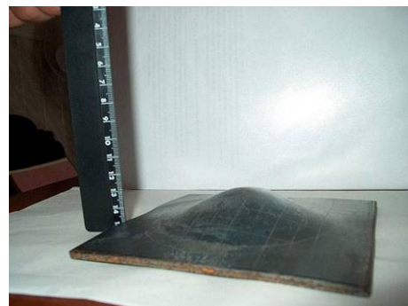
Рисунок 6 - Деформация пластины толщиной 5 мм (эксперимент № 10)
