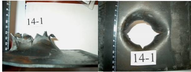
Рисунок 5 - Отверстие в первой пластине толщиной 3 мм
