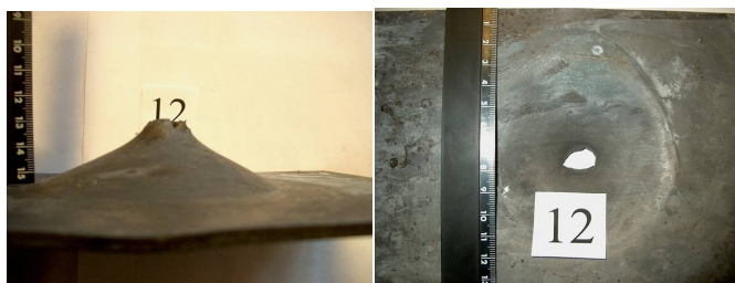
Рисунок 4 - Отверстие в пластине толщиной 3 мм (эксперимент № 12)
