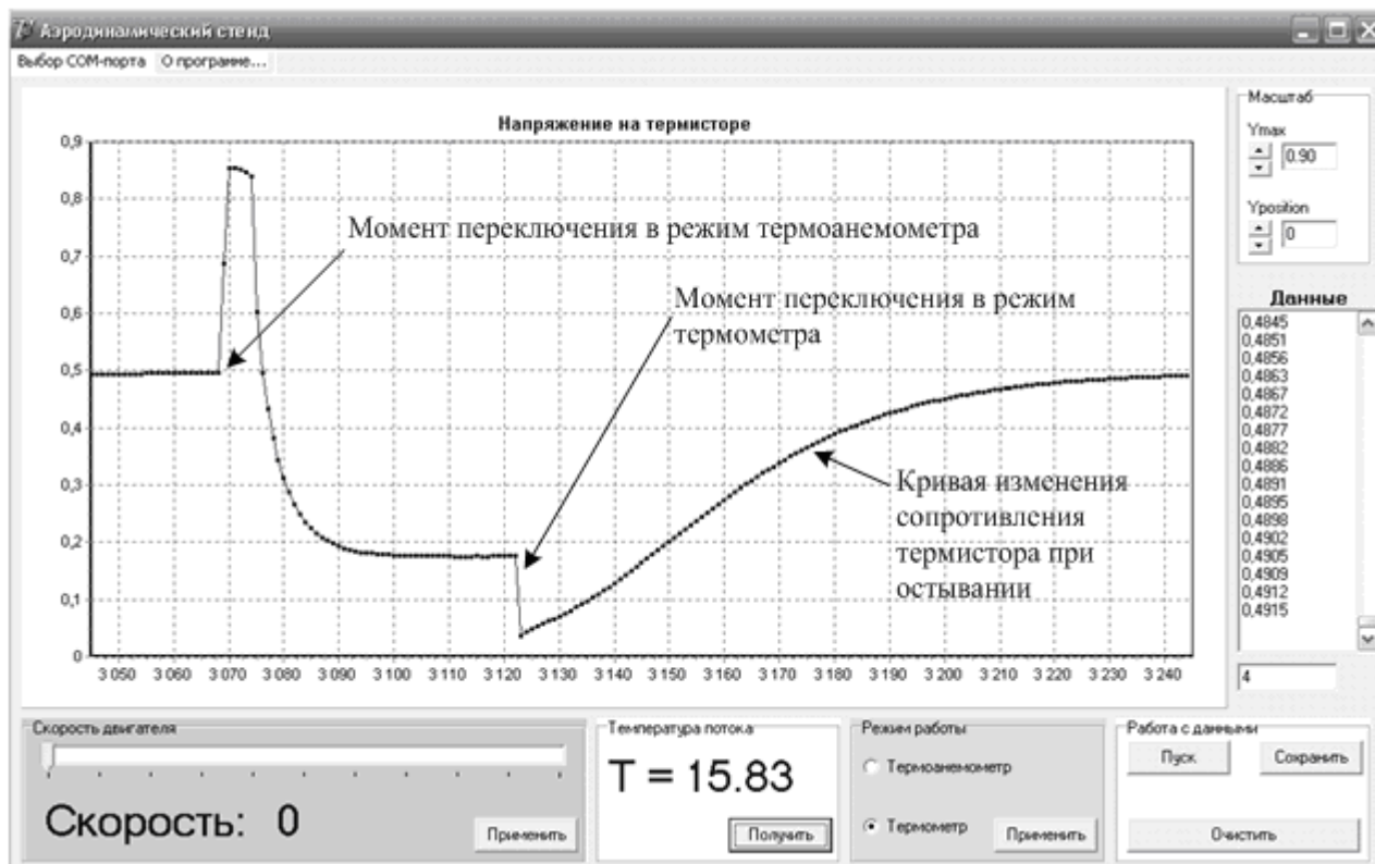
Рисунок 8 – Окно программы управления режимами и регистрации измерительных данных малого аэродинамического стенда
