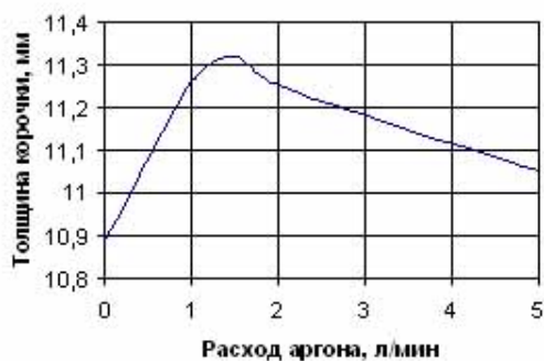
Рисунок 3 - Зависимость изменения толщины корочки заготовки от расхода аргона, вдуваемого в струю стали
