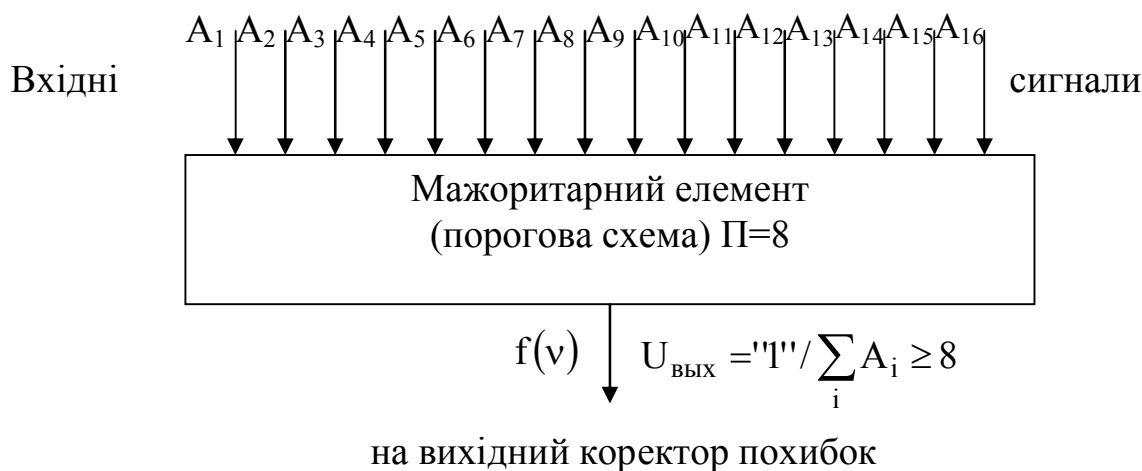
Рис. 4 - Структурна схема мажоритарного елемента на 16 входів і критерій її роботи
