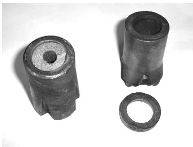
Рисунок 2 – Слом буровой штанги в буровой коронке
