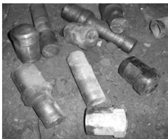
Рисунок 1 – Характерные поломки элементов бурильной головки
