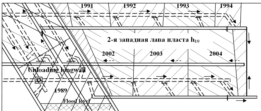
Рис. 1 Схема горных выработок 2-й западной лавы пласта h_{10} «Ливенский» шахты им. М. И. Калинина
