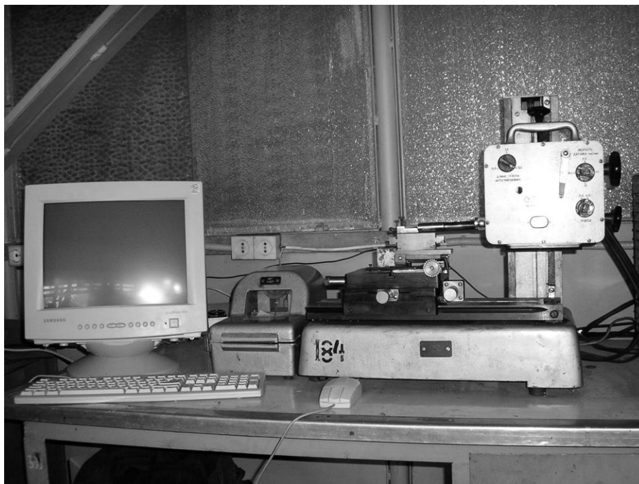
Рисунок 1. Общий вид комплекса для записи профилограммы обработанной поверхности на ПЭВМ
