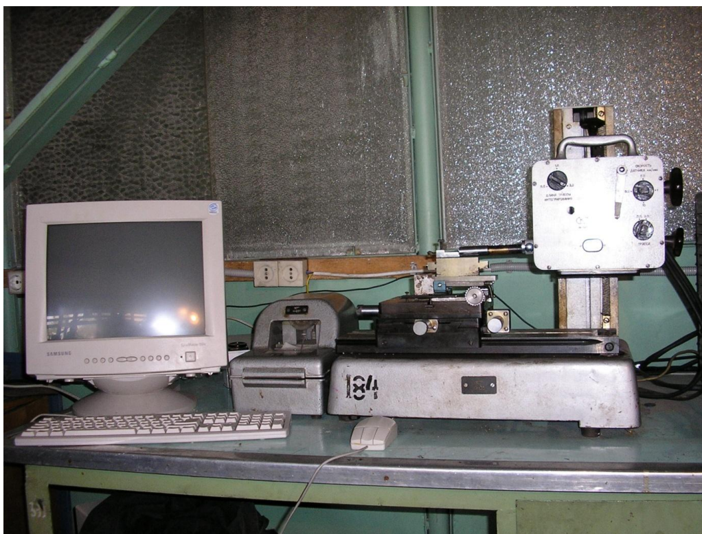
Рис. 2. Общий вид комплекса для записи профилограммы обработанной поверхности на ПЭВМ
