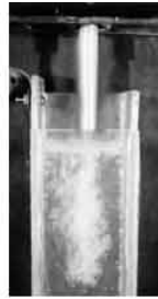
Рис. 3. Розподіл потоків моделюючої рідини в кристалізаторі криволінійної МБЛЗ при різних витратах повітря, що вдувається: а) - 2 л/хв; б) - 5 л/хв; в) - 0 л/хв
