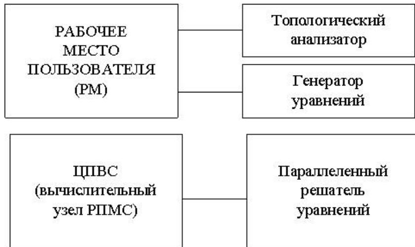
Рис. 3 - Распределение этапов моделирования сложных динамических систем по ресурсам РПМС
