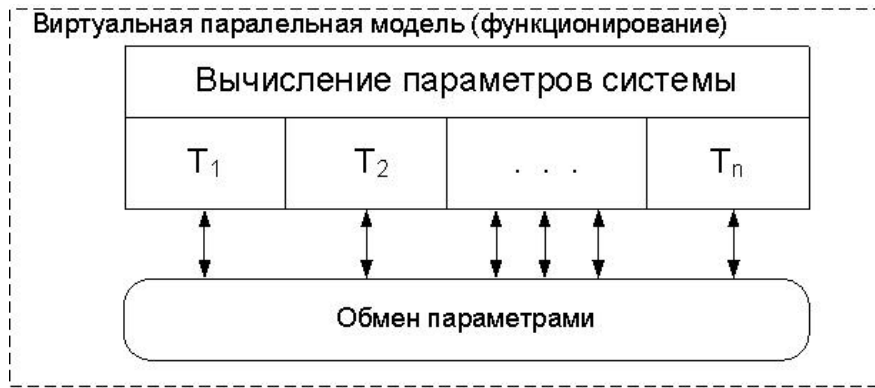
Рис. 5 – Функционирование виртуальной параллельной модели на каждом шаге моделирования
