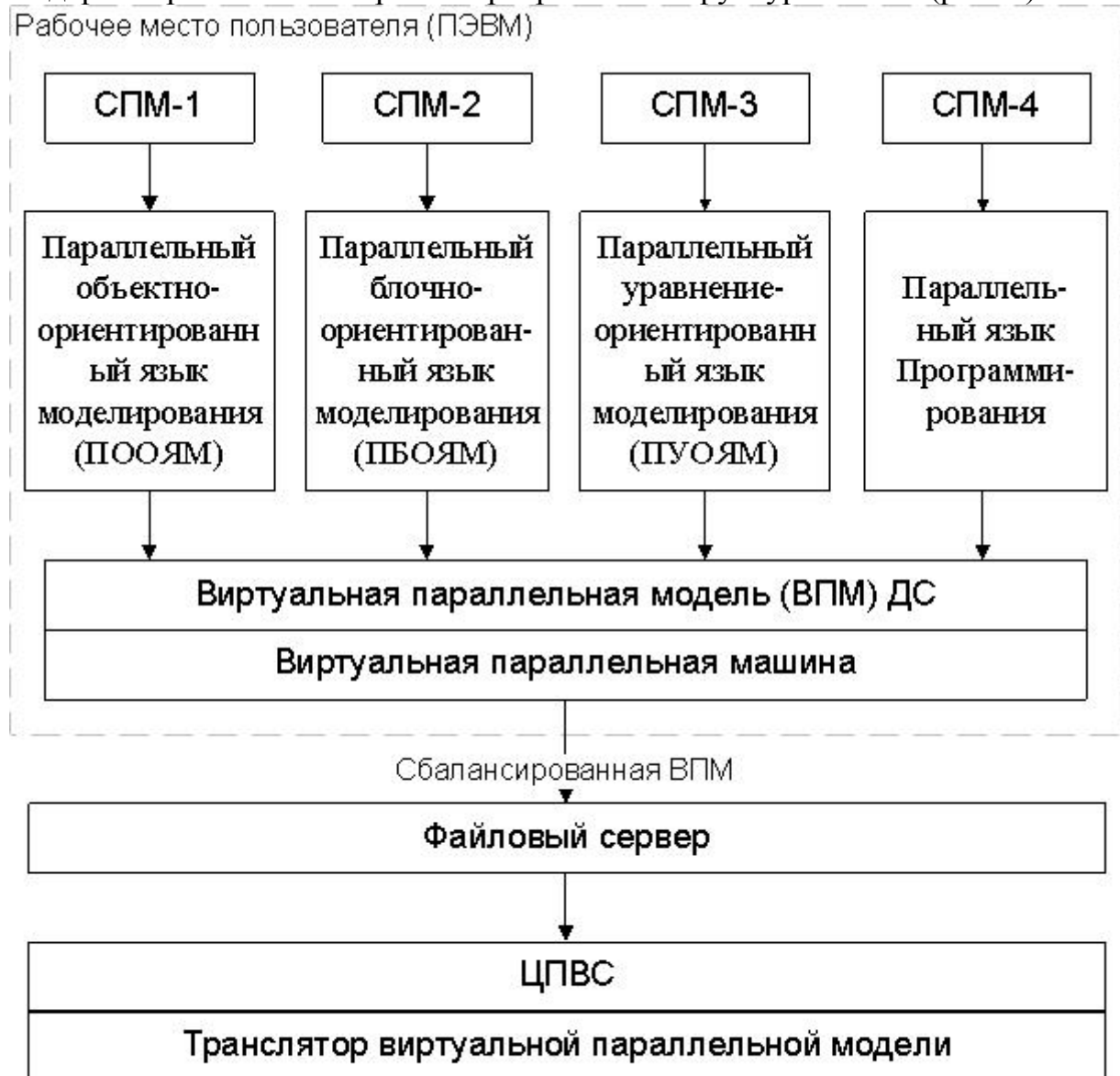
Рис. 7 - Модернизированная аппаратно-программная структура РПМС
