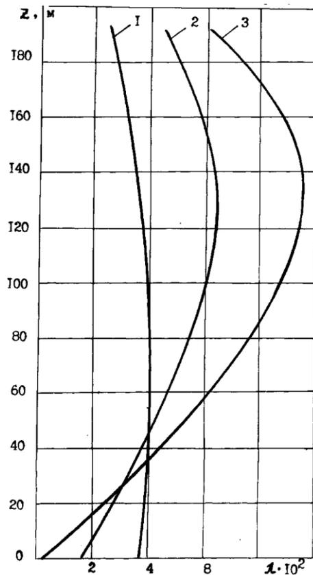
Рисунок 1 – Изменение коэффициента Дарси вдоль подъемной трубы эрлифта при  $\alpha = 0,318$ ;  $h=61\text{м}$ ;  $D=0,15\text{м}$ :
