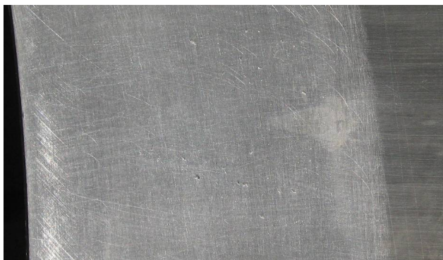
Рисунок 1 – Раковины на беговой дорожке наружного кольца двухрядного роликового подшипника
