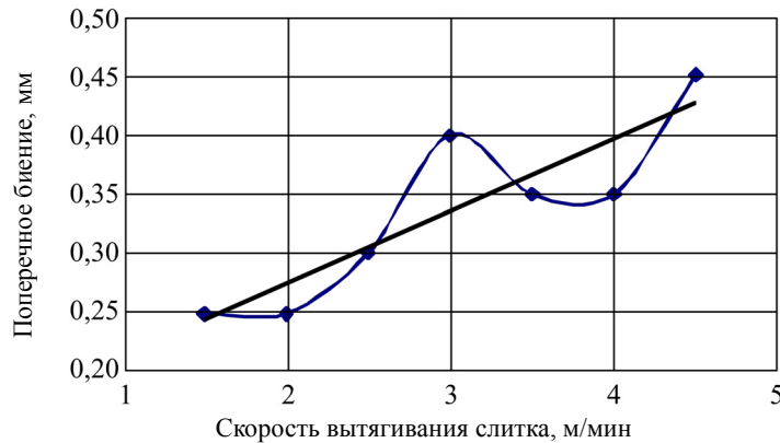
Рисунок 4 – График зависимости между поперечным биением и скоростью вытягивания слитка:
