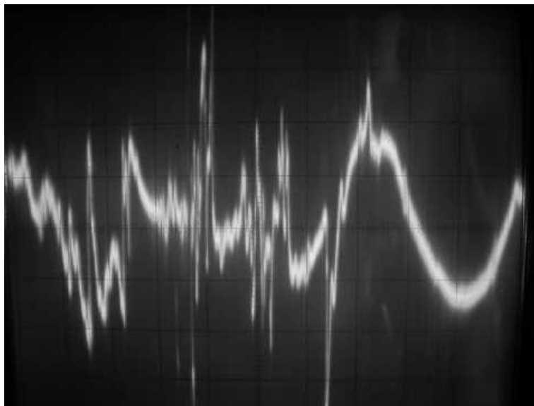
Рисунок 2 – Осциллограмма тока промышленной частоты 50Гц (5В/дел, 5мс/дел, с делителем 1:30, после ВЧ фильтрации) при ослабленном контакте
