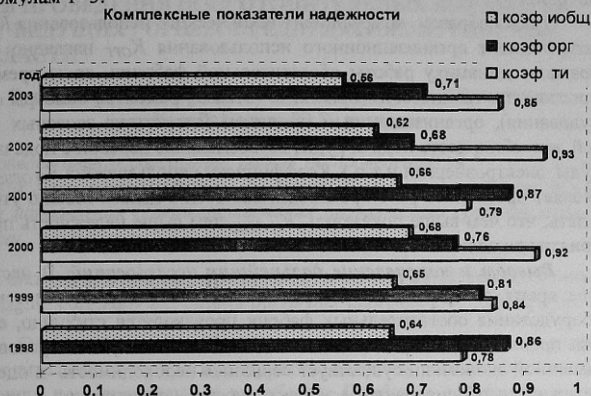
Рисунок 3 - Диаграмма анализа динамики работы обогатительной фабрики по коэффициенту технического использования K_{ТИ} , коэффициенту организационного использования K_{ОРГ} , суммарному коэффициенту использования K_{И ОБЦ}
