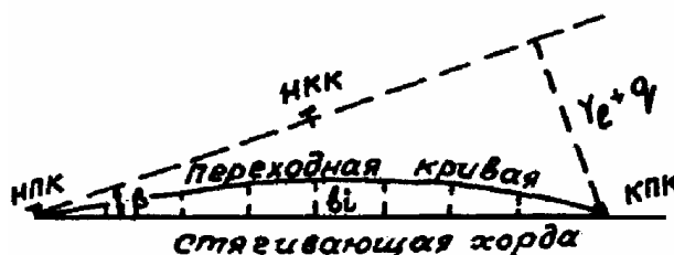
Рис. 2.8 – Схема розбивного кута
