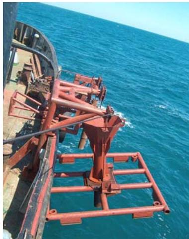
**Рис. 2.24.** Положение набортного оборудования и опоры модернизированного варианта установки УМБ-130М на МБ «Центавр» при коротких переходах
