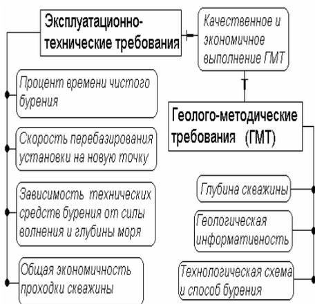
**Рис. 2.** Основные пункты геолого-методических и эксплуатационно-технических требований к бурению инженерно-геологических скважин на шельфе
