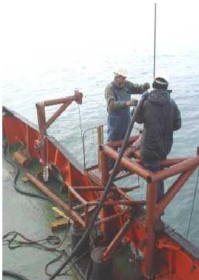
**Рис. 2.23.** Раздельное размещение грузовой стойки и модуля с направляющими стойками (МБ «Шуя», подвязка шланга и троса в процессе бурения)
