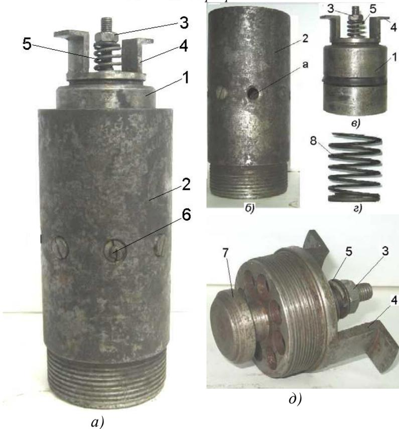
**Рис. 3.15.** Верхний пусковой узел ВПУ-2:
