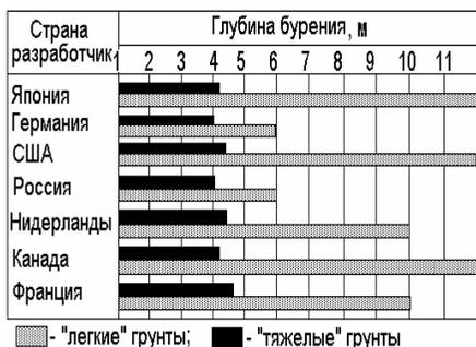
**Рис. 1.2.** Область применения легких технических средств при однорейсовой проходке скважин (ОПС).
