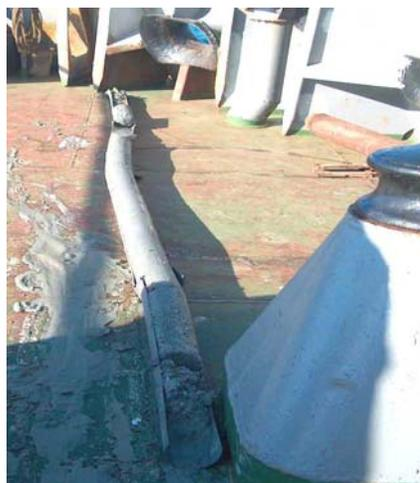
**Рис.1.14.** Фрагмент керна плотной глины, выдавленного в пластиковые желоба (палуба МБ «Центавр»)
