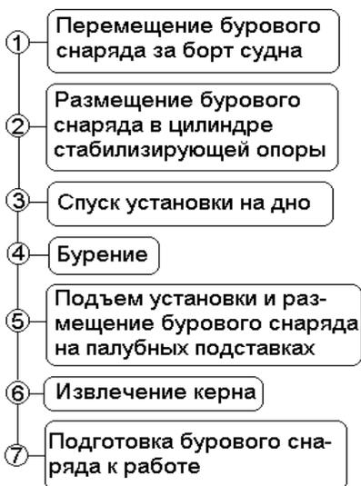
**Рис. 1.30.** Последовательность выполнения этапа «Проходка скважины»
