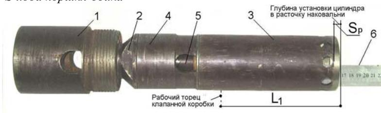
**Рис. 3.5.** Измерение расстояния от рабочего торца клапанной коробки до установочного торца цилиндра ( $L_1$ ): 1 – распределительная коробка; 2 – муфта; 3 – цилиндр; 4 – клапанная коробка; 5 – впускной клапан; 6 – измерительная линейка
