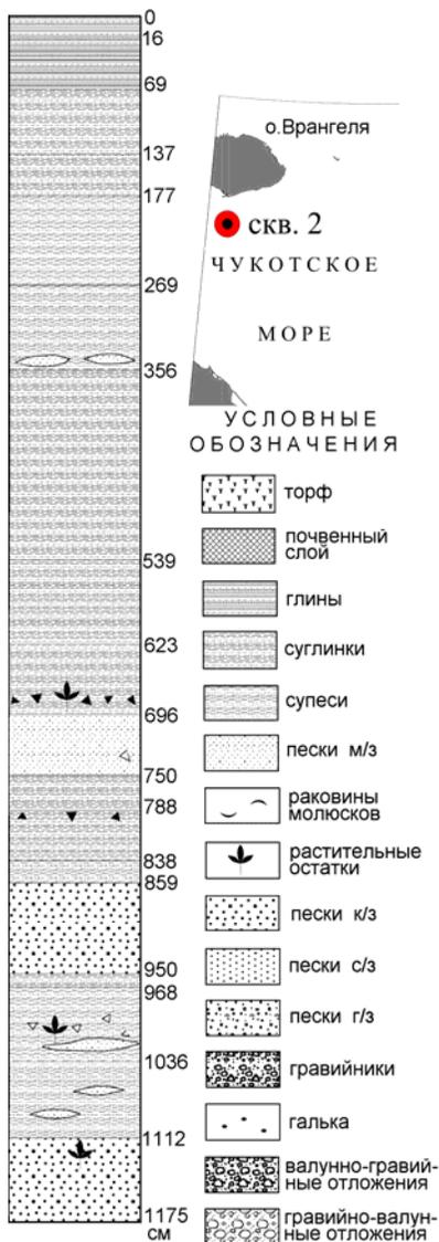
Рис. 2.31. Разрез по скважине №2 в Чукотском море
