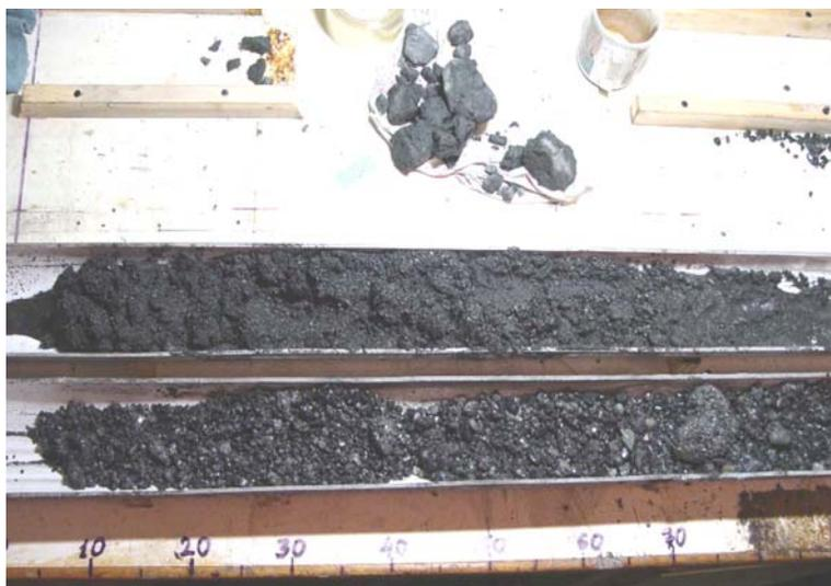
**Рис. 2.29.** Фрагмент керна по скважине №1 (интервал 3,7 – 5,5 м) в Чу-котском море
