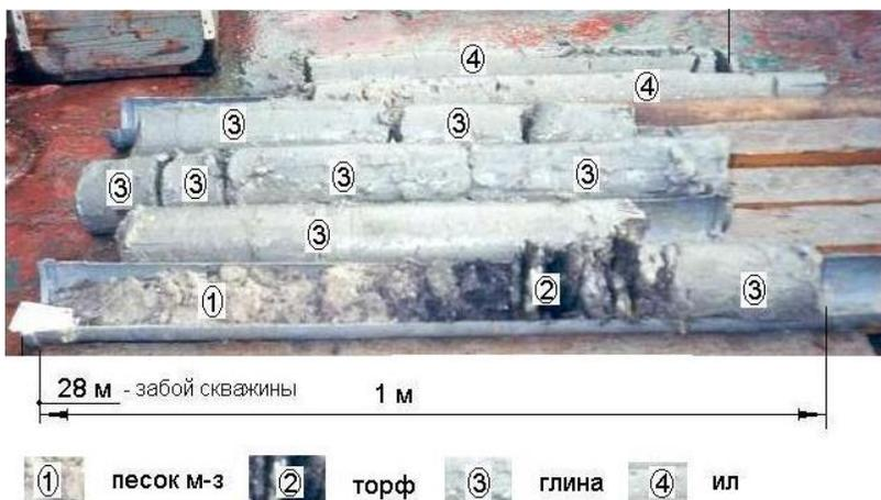
**Рис. 2.19.** Фрагмент керна, поднятого с интервала 22-28 м, по скважине №6
