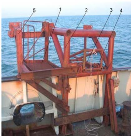
**Рис. 2.22.** Модульное исполнение Г-образных стоек установки УМБ-130М на МБ «Центавр»
