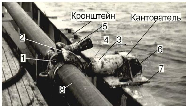
**Рис. 1.26.** Кантователь установки УГВП-130/8 на борту НИС «Топаз»: 1, 2 – полустворки; 3 – корпус; 4 – вал; 5 – гайка; 6 – ось; 7 – опорная плита; 8 – буровой снаряд
