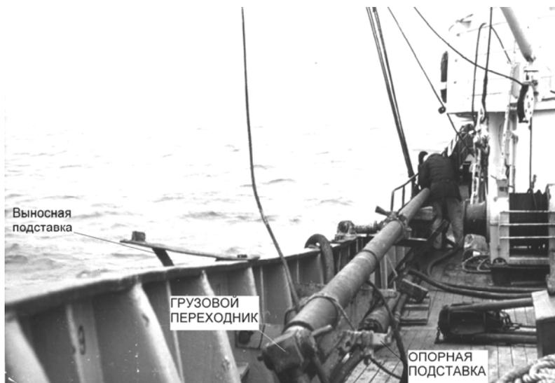
**Рис. 1.27.** Сборка погружного бурового снаряда на опорных палубных подставках
