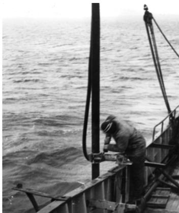
**Рис. 1.33.** Раскрепление хомута кантователя
