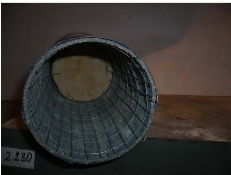
Рис. 3. Общий вид оболочки армированной металлической сеткой при подготовке модели
