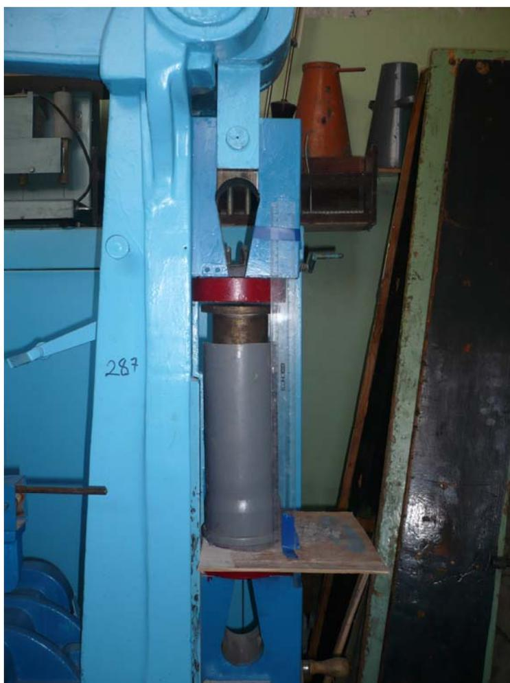
Рис. 4. Нагружение модели на прессе
