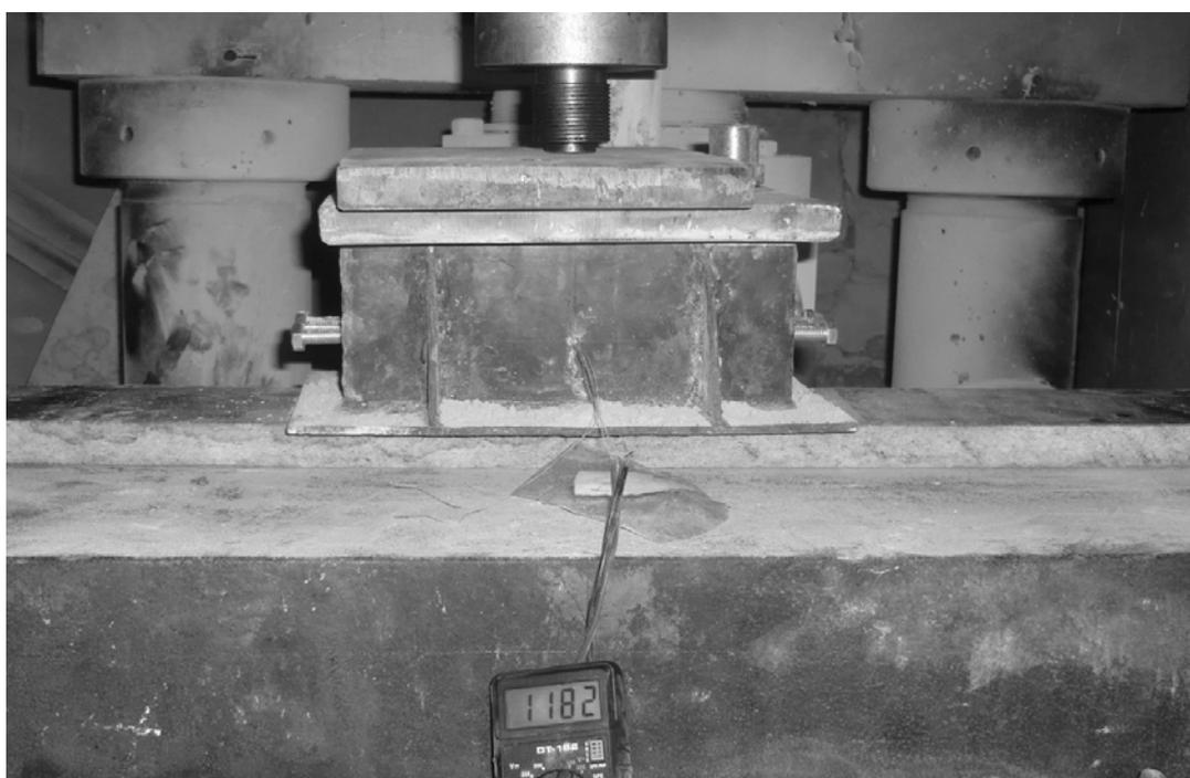
Рис. 2. Общий вид эксперимента по определению давления саморасширения НРВ-80 в различных направлениях
