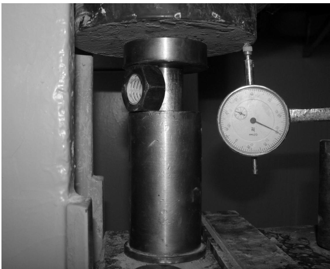
Рис. 3. Положение прибора для изучения давления саморасширения НРВ между плитами пресса
