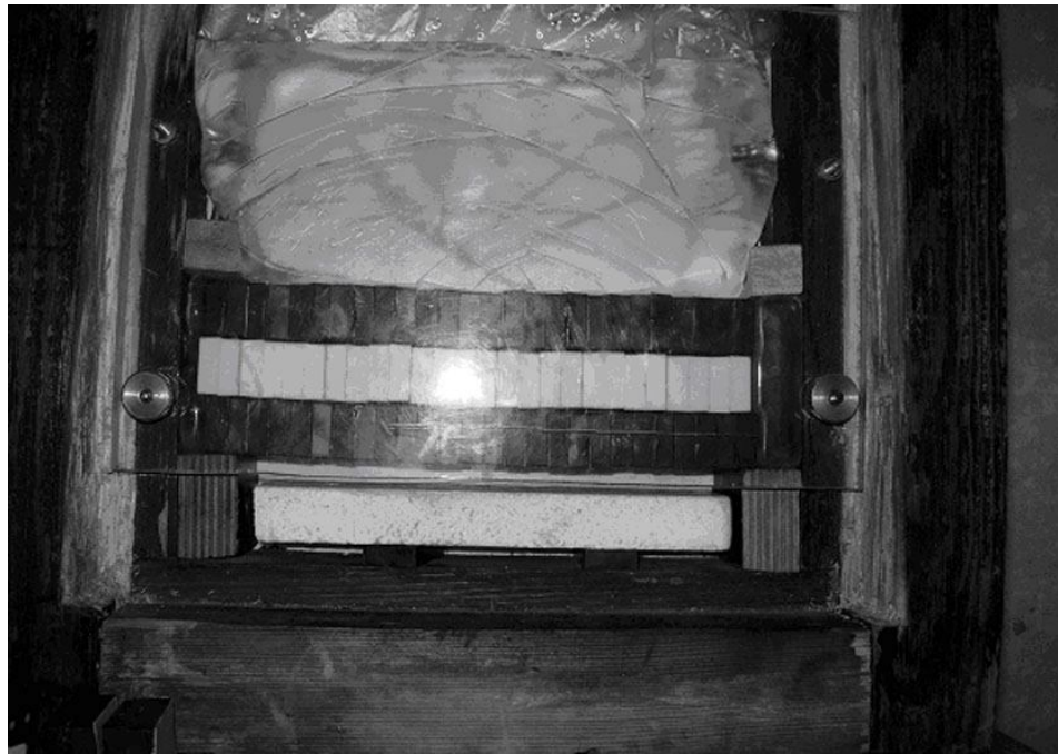
Рис. 7 Общий вид модели при трех слоях структурно однородных элементов до нагружения с пригрузкой.
