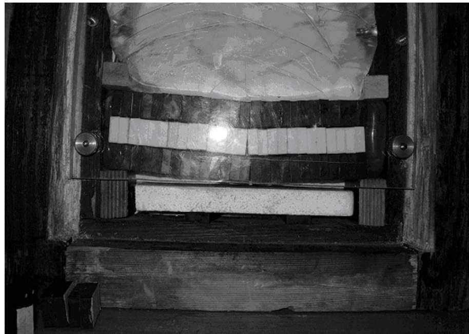
Рис. 8 Общий вид модели при трех слоях структурно однородных элементов после нагружения с пригрузкой.
