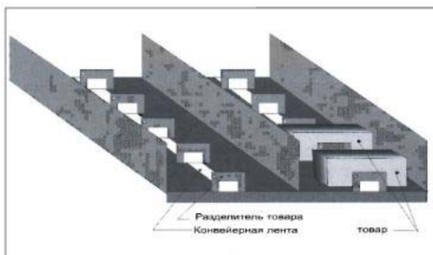
а) б) а) внутренний вид, б) схема загрузки конвейерной ленты
