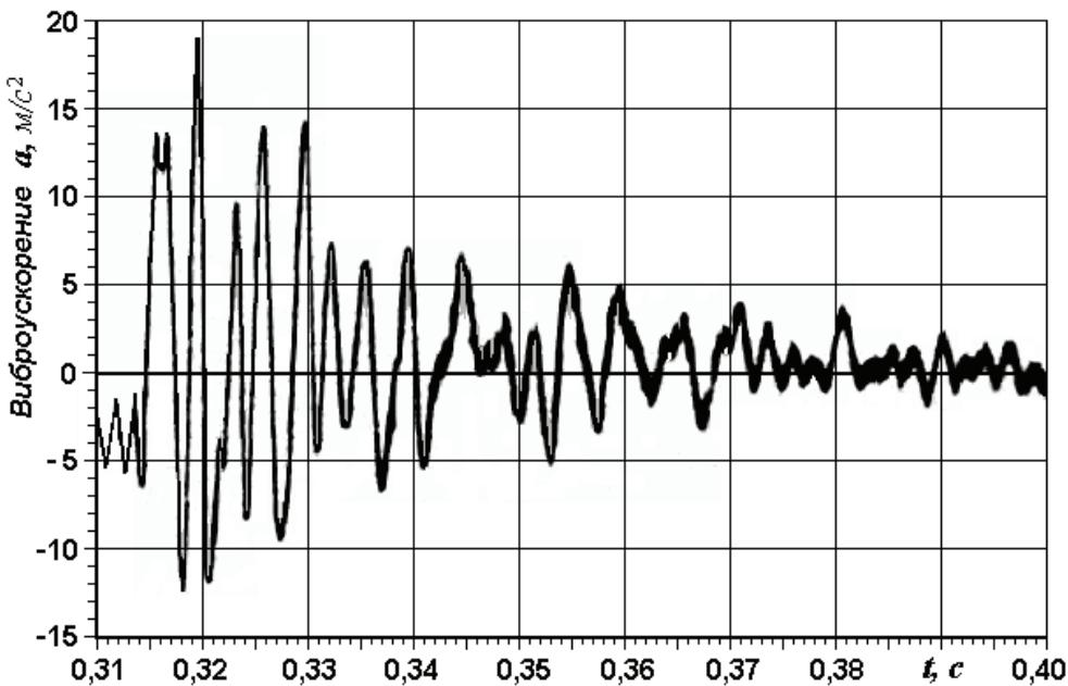
Рис. 1. Форма временного вибрационного сигнала на корпусе редуктора мотор-колеса
