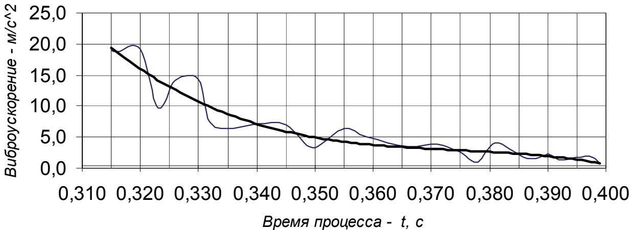
Рис. 2. Огибающие положительных виброускорений корпуса редуктора мотор-колеса
