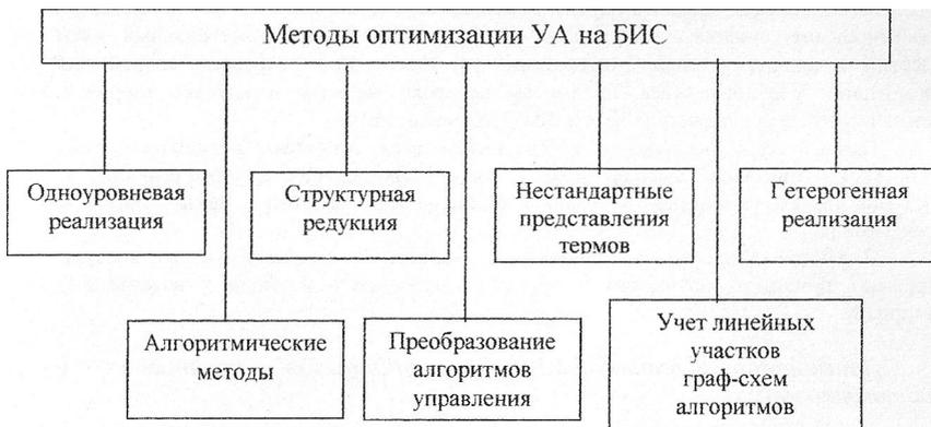
Рис1-Классификация методов оптимизации УА на БИС
