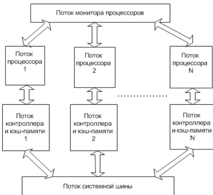
Рисунок 2. Структура имитационной модели мультипроцессора
