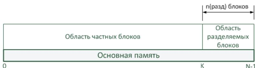
Рисунок 5. Пространство адресов мультипроцессора
