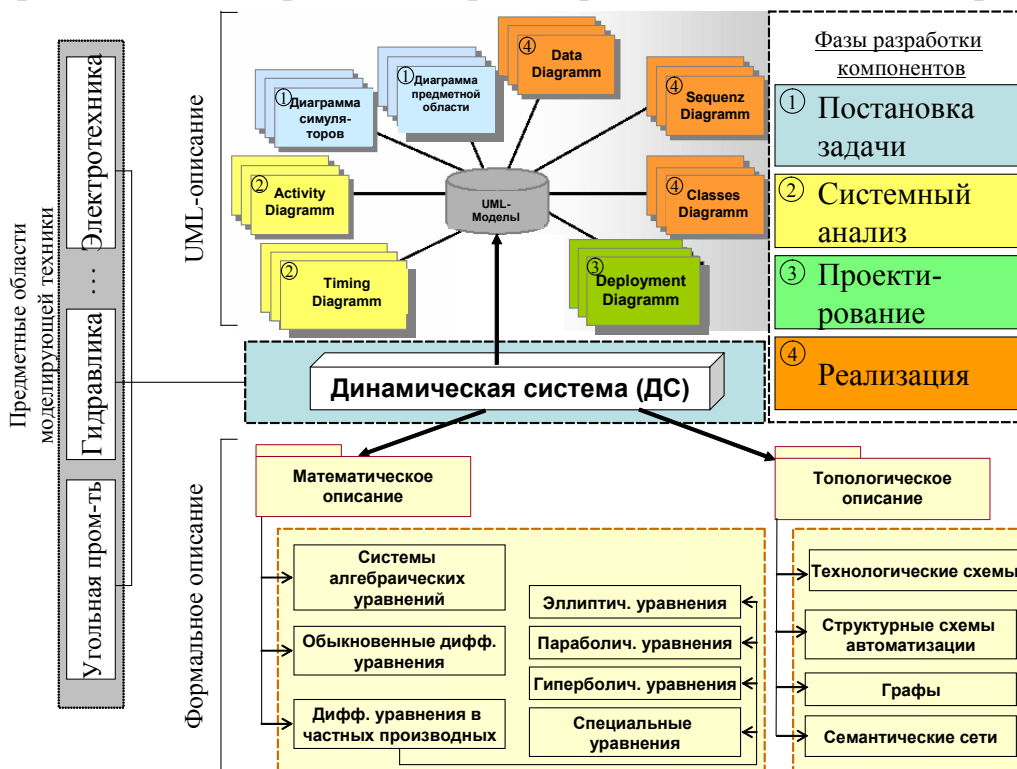
Рис.2. Формальное и UML-базирование описание объектов моделирования.
