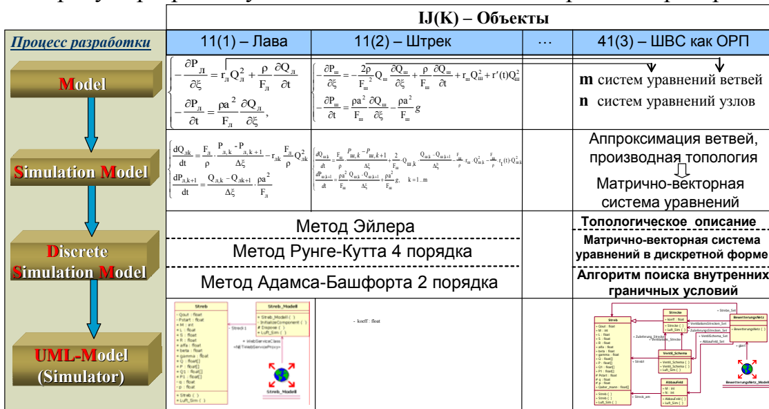
Рис.1. Алгоритм разработки симуляторов для объектов предметной области «Шахтные вентиляционные системы и безопасность труда».
