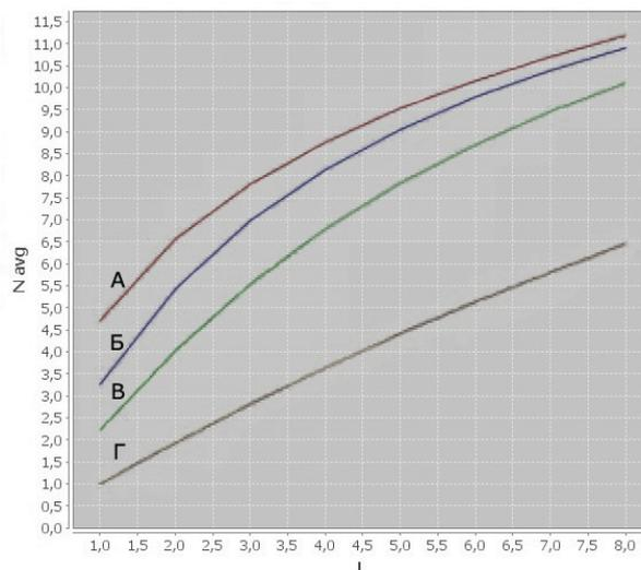
Рисунок 2. Зависимость производительности параллельной ОП с числом модулей  $N=16$  от числа потоков  $L$
