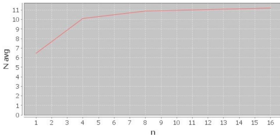
Рисунок 4. Зависимость производительности параллельной ОП от количества модулей  $n$  при неизменном общем числе модулей  $N=16$
