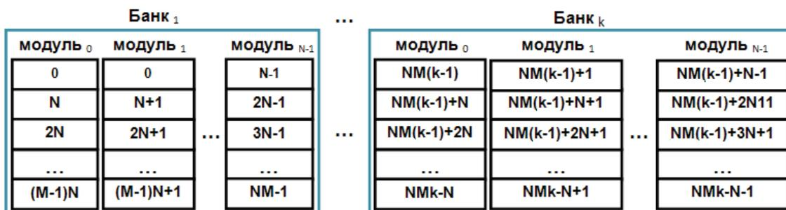
Рисунок 1. Распределение адресов в ОП с чередованием адресов по блочно-циклической схеме расслоения
