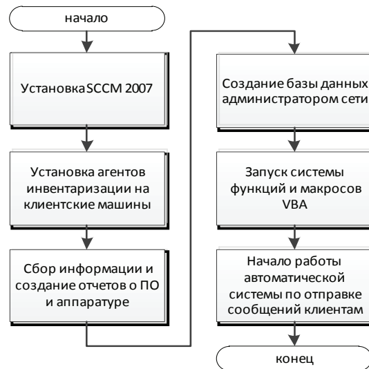
Рисунок 1. Алгоритм для создания и установки системы автоматической отправки сообщений на электронную почту
