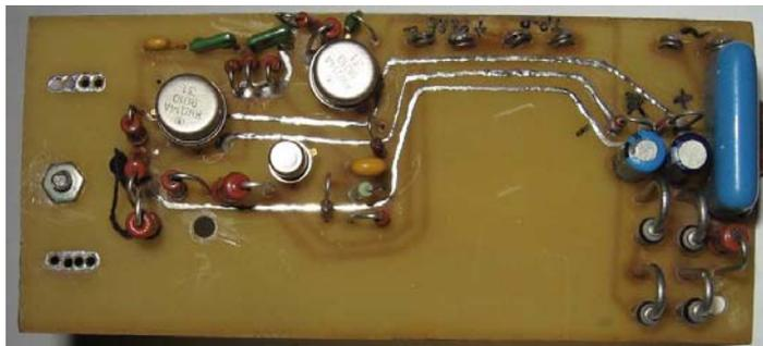
**Рис. 6. Опытный образец устройства искрозащиты квартир**
