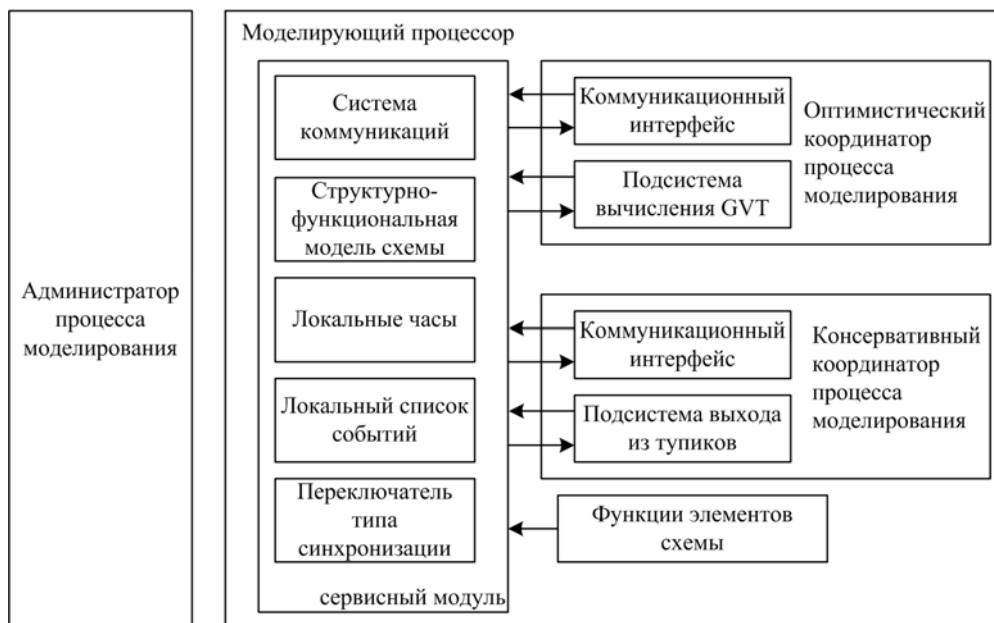
Рис. 2 – Структура подсистемы распределенного моделирования Общие для разных протоколов синхронизации объекты «система коммуникаций», «локальные часы», «локальный список событий», «структурно-функциональная модель схемы» и «переключатель типа синхронизации» содержатся в сервисном модуле.
