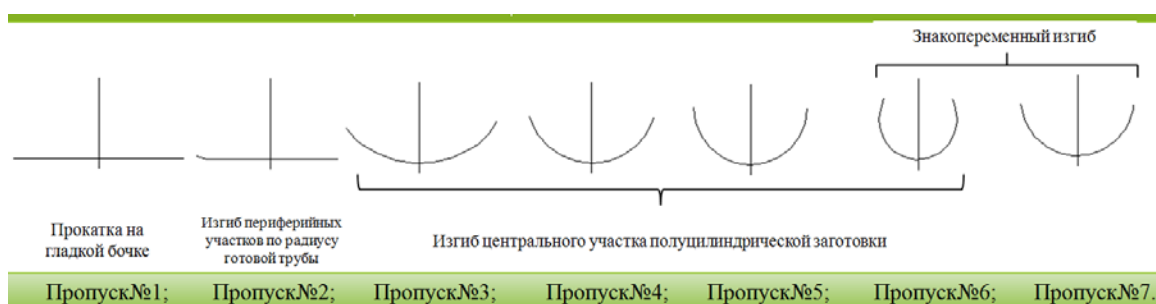
Рисунок 1 – Схема формовки полуцилиндрической заготовки
