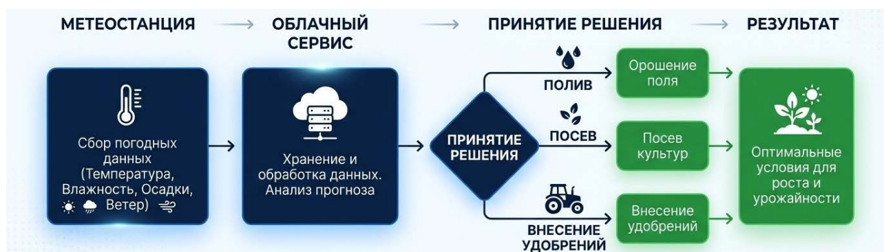
Рисунок 2 – Схема интеграции АМС в технологическую цепочку рекультивации
