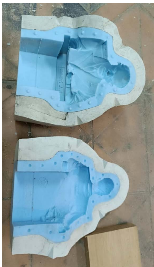
Рис. 2. Изготовление литейной модели.
