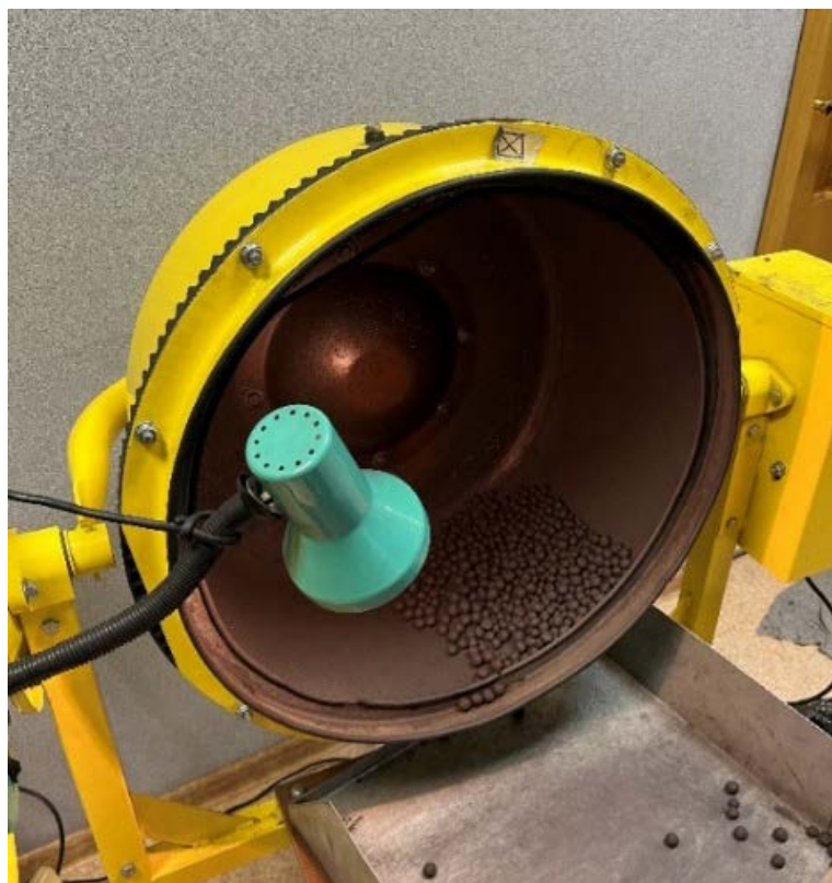
1 – станина; 2 – ходовые колёсики; 3 – барабан для окомкования шихты; 4 – пусковая кнопка; 5 – приёмный поддон; 6 – рычажное колесо регулировки угла наклона барабана; 7 – осветительная лампа
