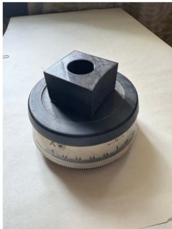
Рисунок 1 – Напечатанная на 3D принтере модель отливки
