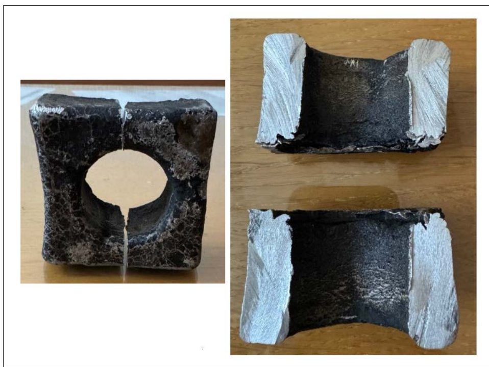
Рисунок 3 – Отливка из алюминиевого сплава АЛ8
