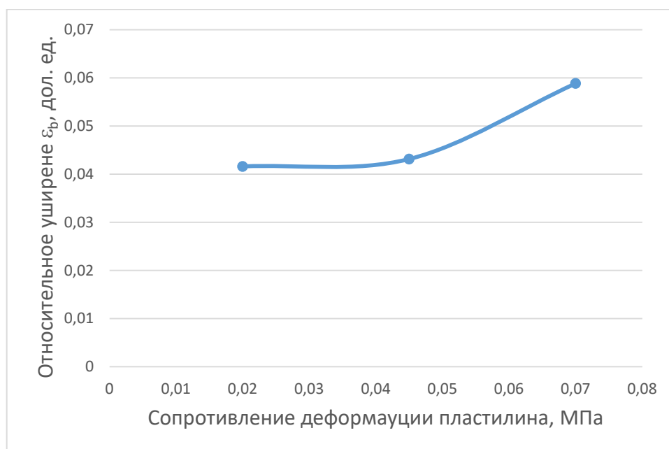
Рисунок 4 – Зависимость среднего относительного уширения от сопротивления деформации
