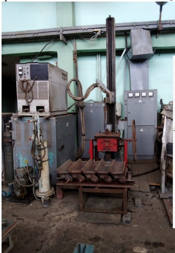
Рисунок 1 Электрошлаковая тигельная печь
