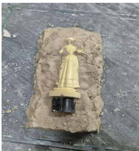
Рис.2 Создание литейной формы
