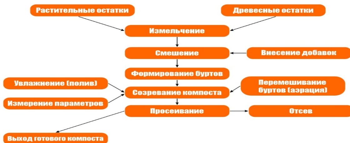
Рисунок 1 — Структура технологического процесса компостирования ДЛО
