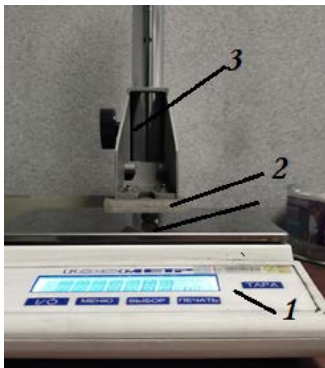
Рисунок 2 – Установка для лабораторного определения прочности окатышей при сжатии
