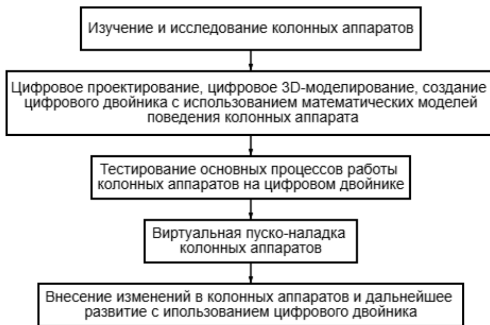
Рисунок 2 – Схема процесса создания и использования цифрового двойника.
