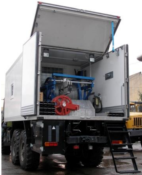
Рис. 15.2. Каротажный подъемник: а – общий вид; б – каротажное отделение; в – секция машиниста
