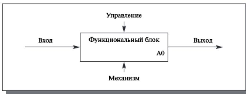
Рис. 42 – Функциональный блок
