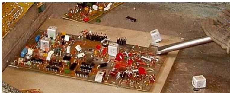
Рисунок 2. Ручная сортировка элементов электронной схемы (печатной платы) по виду превалирующего металла в процессе их срубания.
