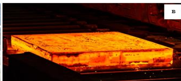
Рисунок 2 – Торцевая поверхность сляба после отделения от непрерывного слитка: а – образование ступеньки; б – слябы для производства тонкого листа; в – сляб для производства толстого листа.
