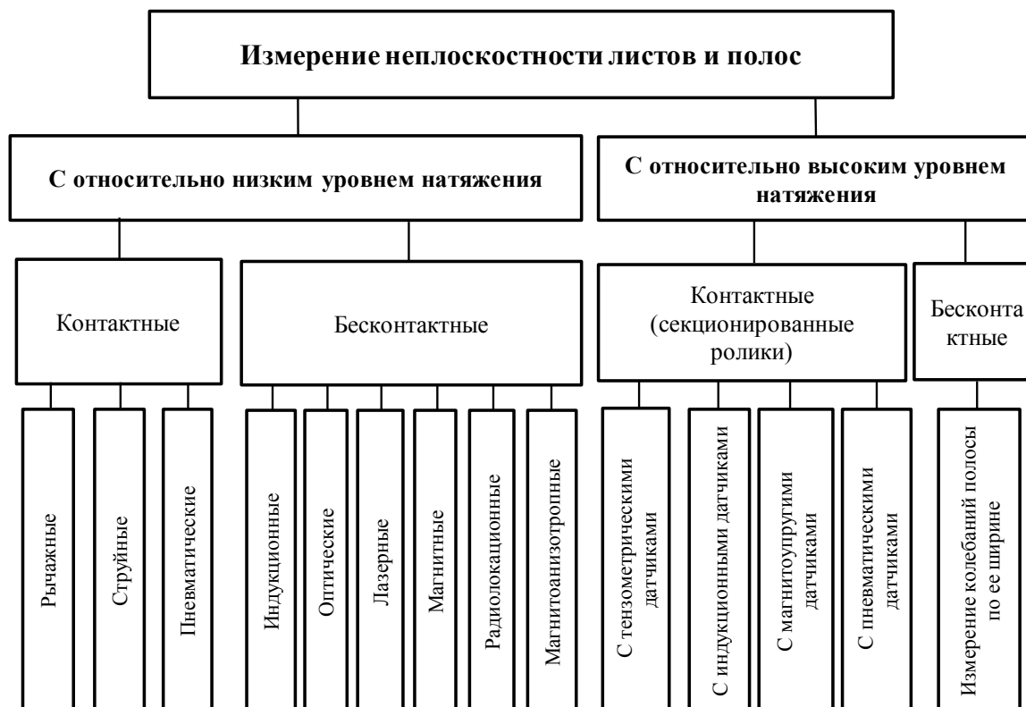
Рисунок 1- Способы измерения неплоскостности листов и полос
