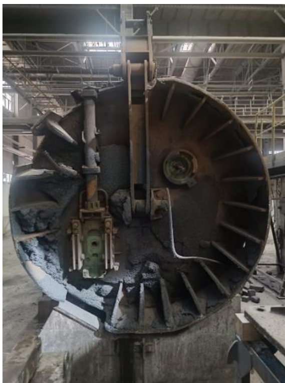
Рисунок 2 – Днище ковша (справа донная продувочная пробка, слева шиберный затвор)
