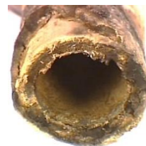
а – отложения солей/кальцитов на выходе воды
