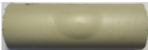
а – дефект на поверхности (вздутие)
