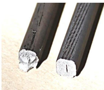
Рисунок 4 – Изломы образцов после испытания на растяжение; слева – закалка 1050 °С, справа – отжиг 950 °С
