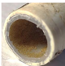
б – коррозионные отложения на внутренней стенке трубы
