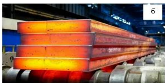
Рисунок 2 – Торцевая поверхность сляба после отделения от непрерывного слитка: а – образование ступеньки; б – слябы для производства тонкого листа; в – сляб для производства толстого листа.
