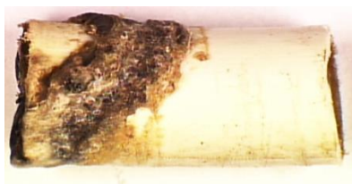
а – отложения солей/кальцитов на выходе воды
