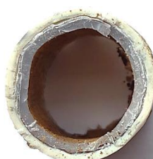
б – коррозионные отложения на внутренней стенке трубы
