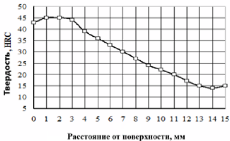
Рисунок 2 – График распределения твердости по сечению образца из стали 40X после наплавки
