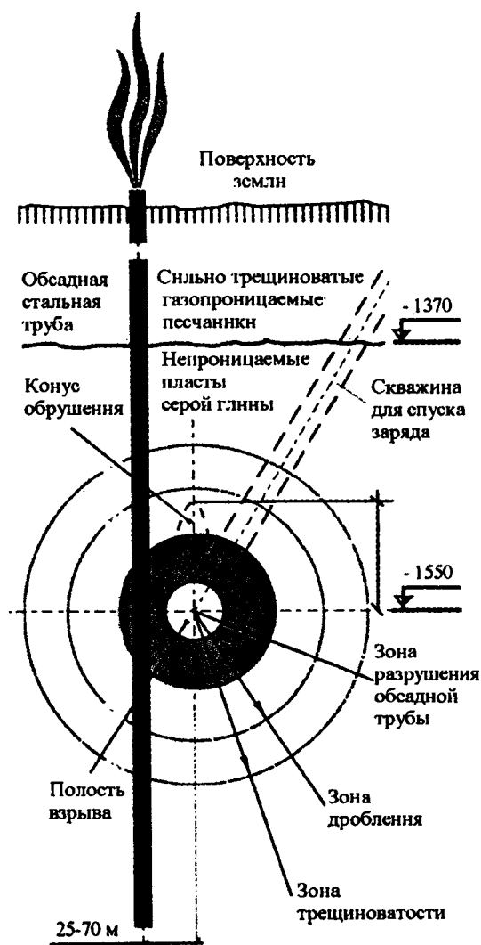
Рис. 5.7 Схема «глушения» газового фонтана в Узбекистане в 1966 г.
