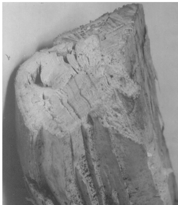
Рис. 6.1 Схематическое изображение предохранительного взрывного патрона ВВ, размещенного на деревянной стойке и результат его взрыва:
