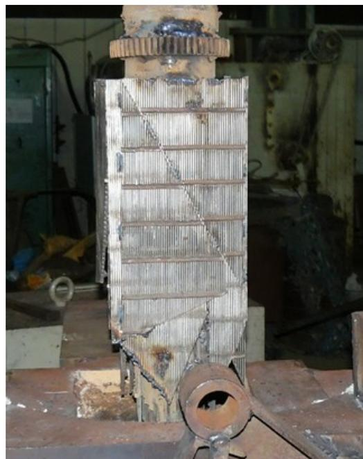
Рисунок 3 – Вид расходуемого электрода из отработанных нагревательных элементов
