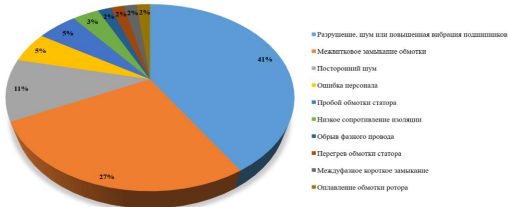
Рисунок 1 – Распределение неисправностей АЭД в процентном соотношении
