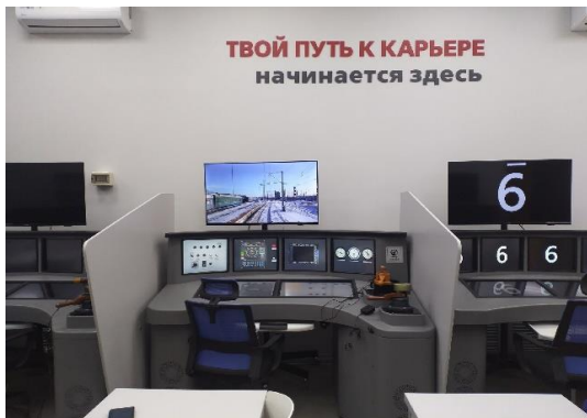
Рис. 1 – Процедурный тренажер А3404.00.00 РЭ (рабочее место)
