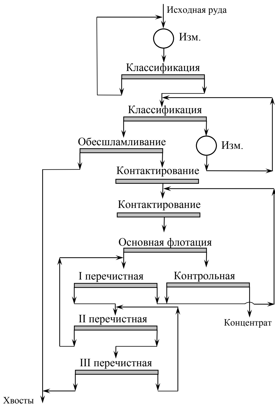
Рисунок 2.8 – Схема флотации окисленных железных руд
