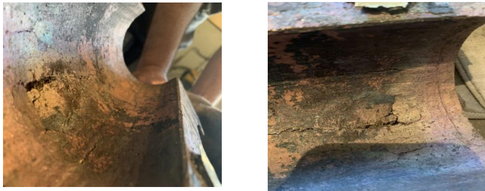
Рисунок 3 – Дефекты отливки, полученной по модели вар. 1
