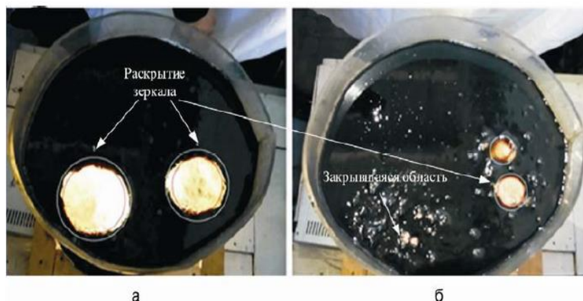
Рисунок 1 - Характер раскрытия зеркала металла при традиционной схеме продувки (а) и с использованием пульсирующей подачи газа (б).
