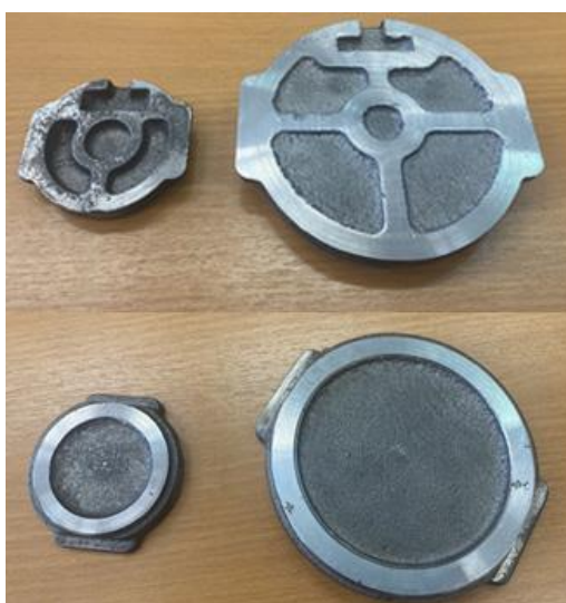
Рисунок 1 - Фото дискообразных отливок, полученных в стопочной литейной форме
