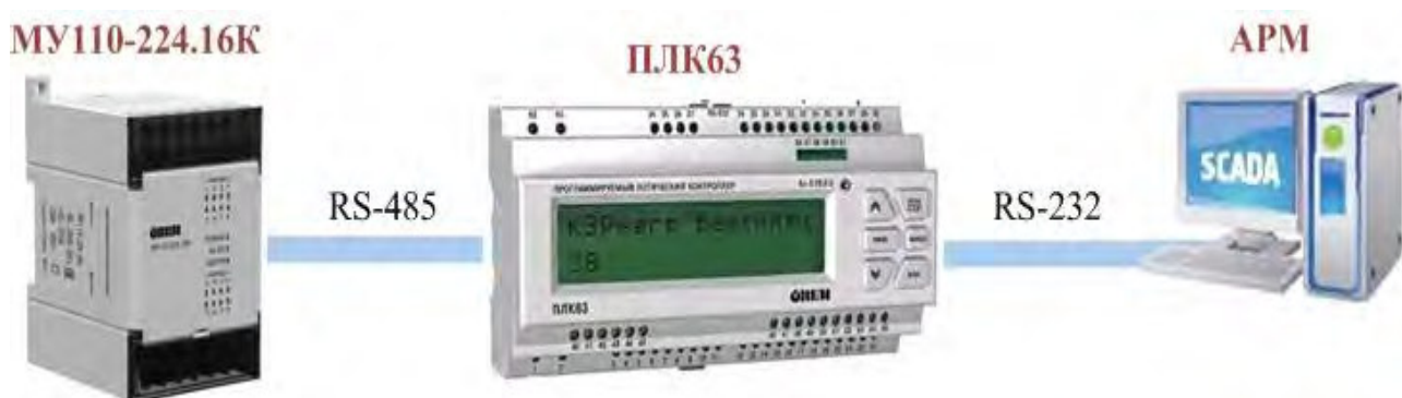
Рисунок 3 – Структурная схема автоматизации станда
