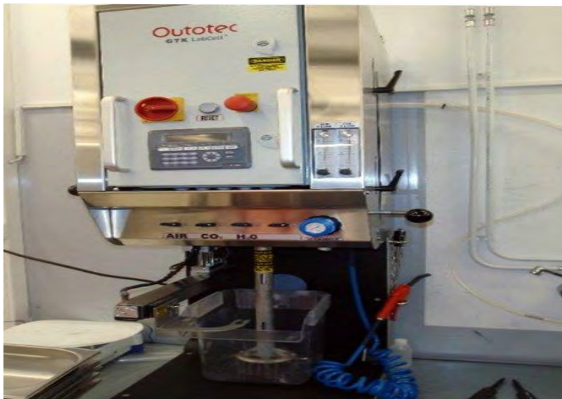
Рисунок 1 – Лабораторная флотомашинa Outotec GTK LabCell™ имеет регулируемую подачу воздуха и скорость вращения импеллера и оборудована механизмом автоматического пеносъема.
