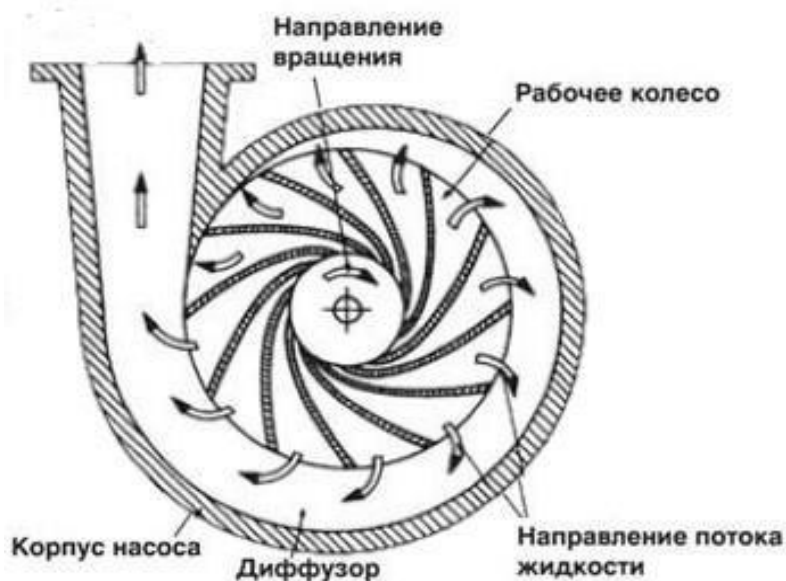
Рисунок 1 – Принцип действия центробежного насоса
